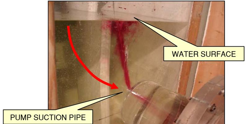
FIGURE 9: SURFACE VORTEXING
